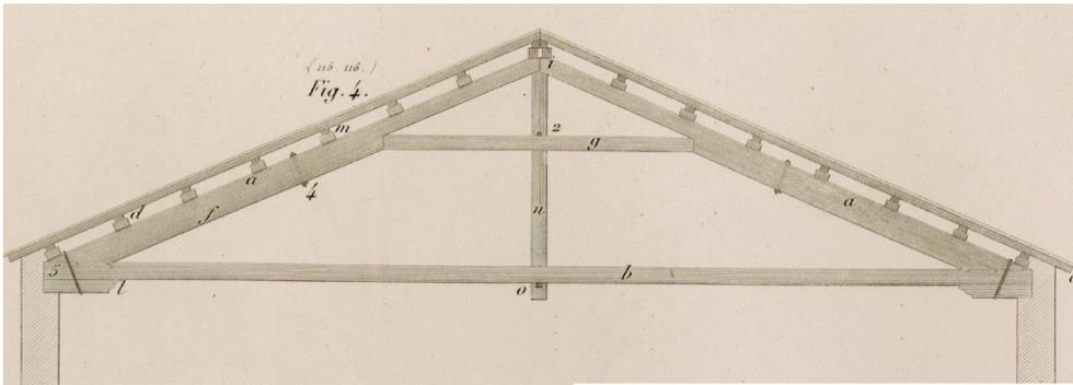
Figure 2: Rondelet's drawing of the trusses of San Paolo FLM. (Source: *Traité théorique et pratique de l'art de bâtir*, Pl. 105.)
